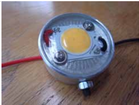
Фиг. 21.19. Източник на светлина - LED Array с мощност 20W
