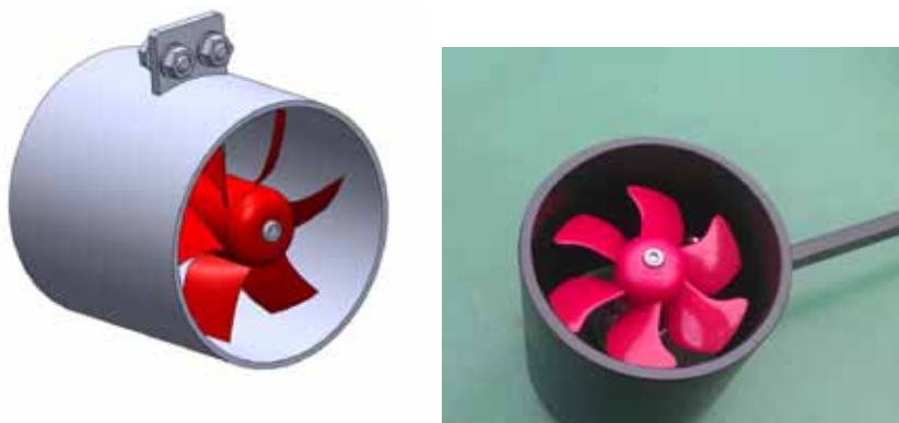
Фиг. 21.5. Проект и реализация на тръстер
