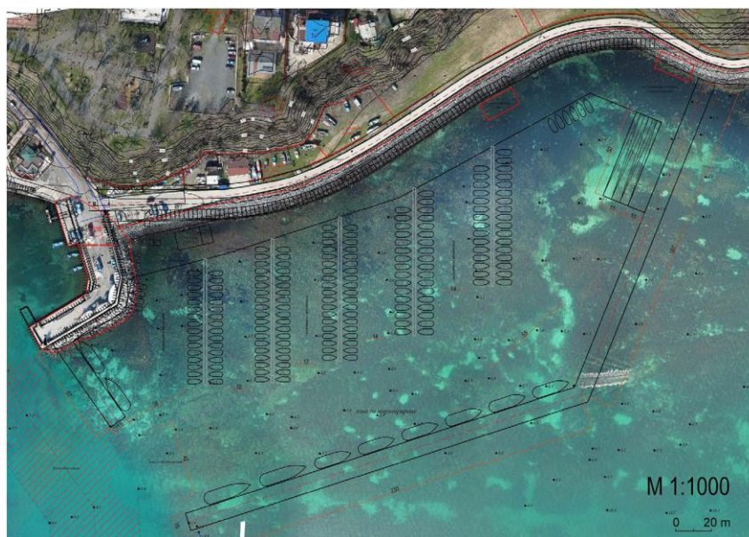
Фигура 7. Картосхема на проекта на бъдещия пристан и граници на акваторията за малки плавателни съдове („ЛТ Консулт“ ЕООД).
