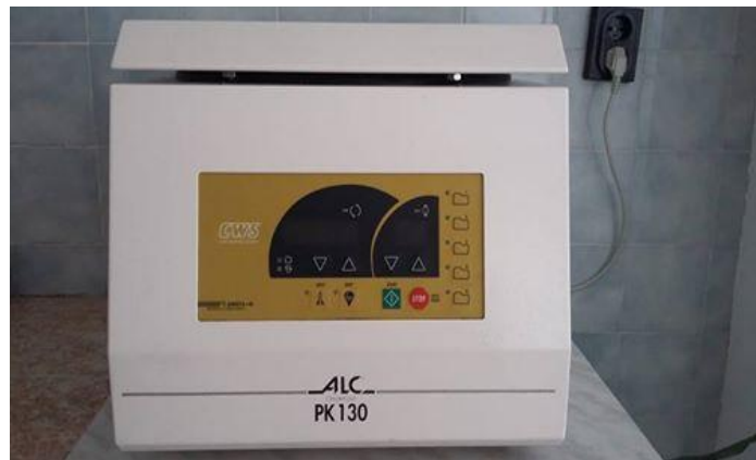
Центрофуга ALC, mod. PK 130 - за анализ на концентрацията на хлорофила
