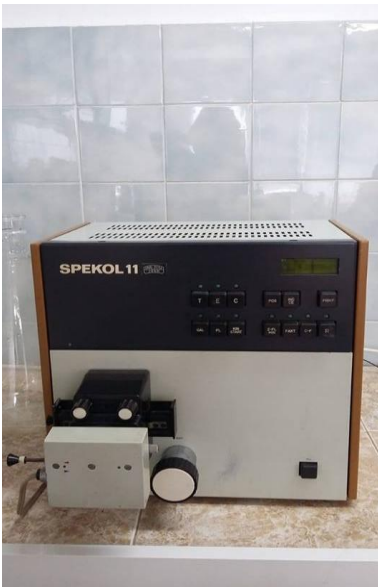
Спектрофотометър SPEKOL 11 - за анализ на концентрацията на хлорофила
